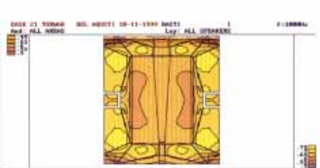
Fot. 5 Mapa zrozumiałości mowy dla hali Torwar” – po adaptacji akustyki, z głośnikami RCF serii VISION
